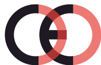
Marcatura CE contraffatta (troppo vicino)
